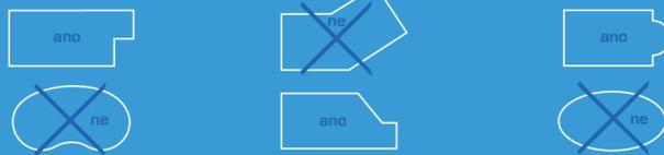
**Varování:** Aby byly splněny veškeré bezpečnostní vlastnosti, mezera mezi okrajem bazénu a okrajem krytu nesmí být větší jak 70 mm. Tohoto výsledku lze dosáhnout poskytnutím plánu výroby bazénu. Tento plán by měl důkladně znázorňovat délku bazénu i jeho šířku změřenou na metry. Minimální a maximální hladina vody požadovaná na jmenovitou hodnotu je +/- 3 cm. Minimální hladina vody pro období zazimování musí těmto podmínkám odpovídat.
